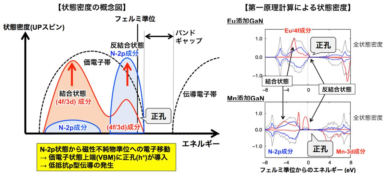
図：状態密度<sup>※9</sup>による解釈。結晶に広がった N-2p 軌道と局在した 4f (3d)軌道との強い共有結合性による p-f (p-d)混成のため、エネルギーの深い位置に局在した 4f (3d)電子を主成分とする結合状態 (N-2p 成分は少ない) が出現し、閉殻構造(4f<sup>7</sup>や 3d<sup>5</sup>)に近い電子状態をとる。一方、p-f (p-d)混成による広がった N-2p 軌道を主成分とする反結合状態が価電子帯上端 (VBM) に出現する。電荷中性を保つため、正孔(h<sup>+</sup>)が主として広がった N-2p を主成分 (4f や 3d 成分は少ない) とする不純物バンドにドーピングされるため、4f<sup>6</sup> → 4f<sup>7</sup>+ h<sup>+</sup>@VBM、および 3d<sup>4</sup> → 3d<sup>5</sup>+ h<sup>+</sup>@VBM、の電子状態が実現される。
